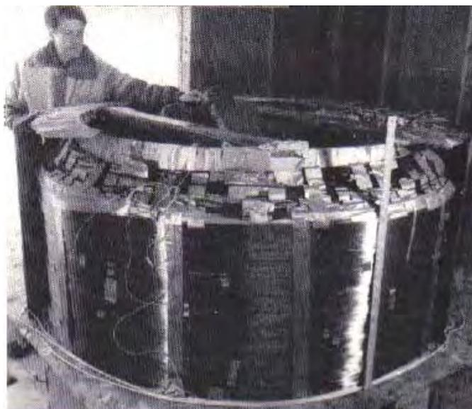
Ce prototype a utilisé le fil couleur cuivre isolé de 5 calibre pesant 4,200 livres et 300 livres de blessure métallique couleur cuivre de 30 calibres sur la sinuosité de 5 calibres et un diamètre de 4 pieds de long, de 20 pouces massif l'aimant permanent d'environ 600 livres dans le poids. Le rouleau était la blessure avec un diamètre intérieur de 4 pieds et d'une hauteur d'environ 3 pieds, la blessure sur un tube de fibre de verre. Le poids général était environ 5,000 livres.
