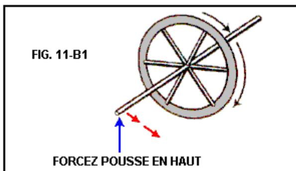
alors l'axe bouge dans la direction opposée comme montré par les flèches rouges. Cet effet est, évidemment, inversé si la direction de rotation du gyroscope est inversée (comme ce sera si vu de l'autre côté, au même titre que la direction d'écoulement actuelle dans le fil est inversée si les pôles magnétiques sont échangés).
