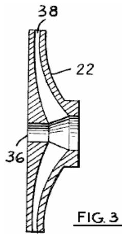
**Fig.3** est un profil et une section du pousseur et
