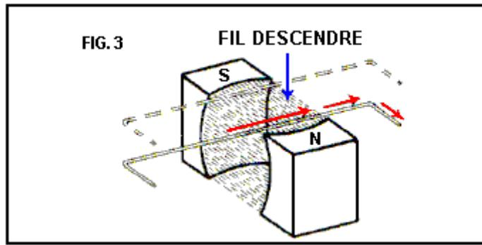
Si vous tournez le champ magnétique dans l'autre sens en inversant la position des champs magnétiques et déplacez ensuite la boucle métallique au même titre qu'auparavant, les écoulements actuels dans la direction opposée. Comment le courant "sait-il" quel la façon de couler, ou quel la voie autour des aimants est tournée comme il ne les touche pas ?
