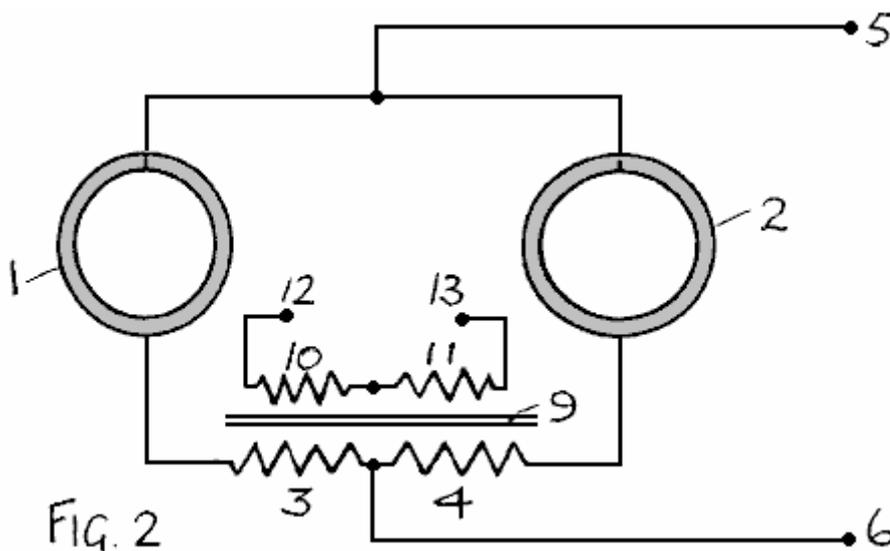
Se rapportant à la **Fig.2**, les inducteurs 3, 4 sont montrés pour avoir un coeur de ferrite commun 9 et avoir windings secondaire 10,11, qui, par l'action de transformateur, peut fournir la production de génération électrique entre les terminus 12 et 13.
