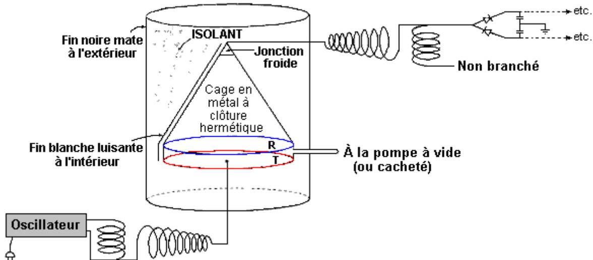
Où les plaques de pick-up actives **R** et **T** sont encasés dans un cylindre et sont fournies avec une forme de cône pour aider la procédure. L'application brevetée contient beaucoup d'informations et vaut la peine de lire.
