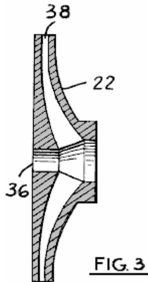
Dans la **Fig.3**, le pousseur **22** est montré plus en détail, où **38** est le passage liquide et **36** est l'ouverture pour l'arbre d'entraînement.
