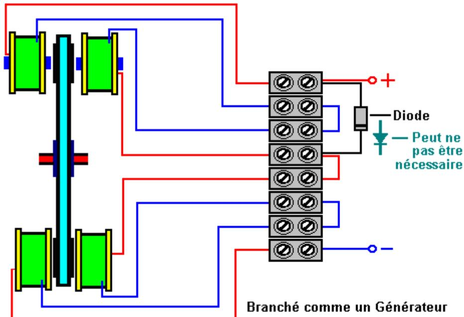
En cas de l'arrangement de Générateur, vous avez l'option pour raccorder chacune des quatre paires dans le parallèle comme dans l'arrangement Automobile ou les raccorder en série. Raccordé dans le parallèle, les rouleaux peuvent soutenir une plus grande attraction actuelle, pendant que si raccorderé en série, ils fournissent un plus haut voltage. Le voltage pourrait être davantage augmenté en augmentant le nombre d'allume chaque rouleau.
