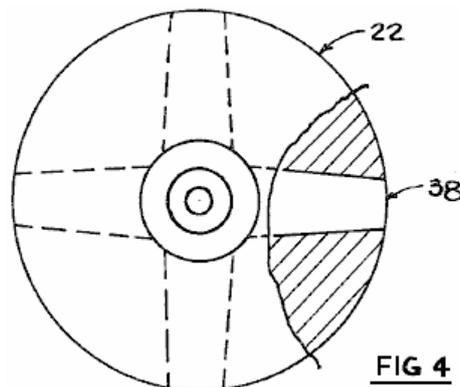
Dans la **Fig.4**, le pousseur est montré, avec **22** étant le pousseur et **38** étant le passage liquide.
