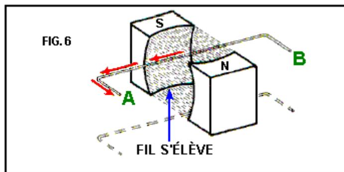
Maintenant, si la boucle métallique est débranchée et retournée, la partie qui était à "A" maintenant déplacé à "B" et le même mouvement du fil réalisé - l'écoulement actuel est dans exactement la même direction bien que son sentier le long du fil soit inversé (parce que le fil a été inversé). Cela montre que la direction d'écoulement actuel n'est pas affectée par le fil lui-même.
