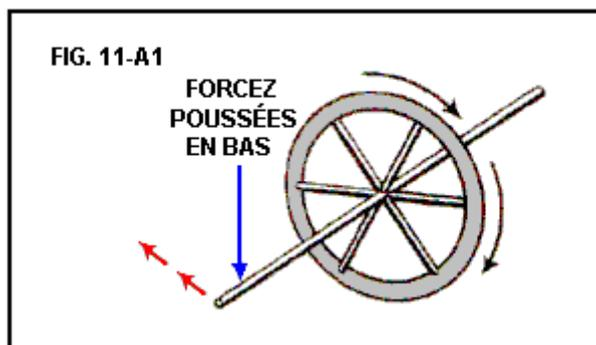
Ici, si l'axe du volant tournant, ou du gyroscope, est appuyé en bas il part dans la direction montrée par les flèches rouges. Pourtant, si l'axe est appuyé en haut :
