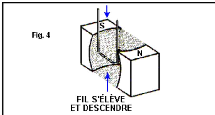
Le point intéressant suivant est que si la boucle métallique est déplacée en haut et en bas entre les aimants, mais a tourné pour être parallèle au flux coulant entre les pôles, donc aucun écoulement actuel dans le fil, peu importe comment vite le fil est déplacé en haut et en bas.
