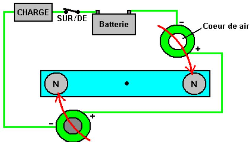
Ici, il n'y a aucun fil électrique ou magnétique traînent sur le rotor comme les aimants partent des rouleaux. La batterie fournit le courant à la charge de la façon normale et l'arrangement de rotor n'a aucun effet sur l'opération du circuit.
