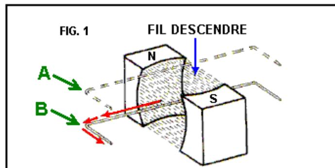
Ici, une boucle de fil est déplacée en bas du niveau "A" au niveau "B". Ce mouvement fait un courant électrique couler à gauche le long du fil comme montré par les flèches rouges. La question de Joseph était "pourquoi entre-t-il dans cette chaque fois de direction le fil est déplacé de cette façon ?"
