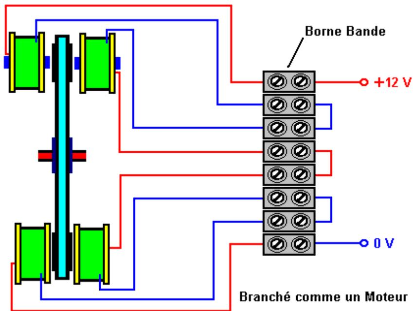
Avec cet arrangement, pour chaque rotor, toutes les quatre paires de rouleaux Creux sont télégraphiées dans le parallèle l'un à travers l'autre et tous les quatre rouleaux Creux-aériens sont télégraphiés dans le parallèle l'un à travers l'autre. Pour améliorer la clarté, le susdit diagramme montre seulement une des quatre paires, mais en réalité, il y aura quatre fils entrant du côté de main gauche de chacun des terminus de vis.
