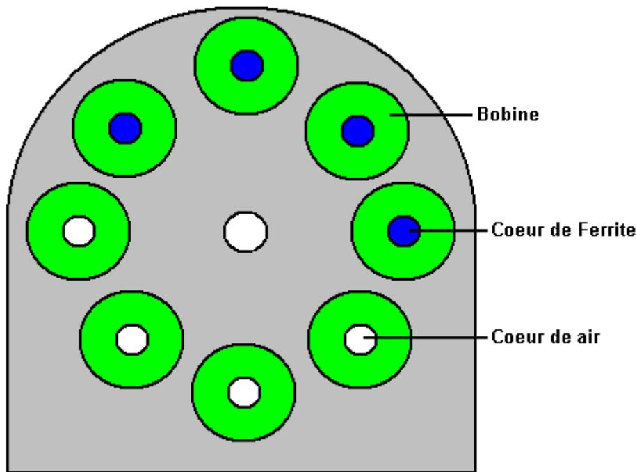
Ferrite est une meilleure matière pour les coeurs des rouleaux. Les stators vont chaque côté des rotors et du trou au milieu des stators doivent donner le déblayage pour le puits sur lequel les rotors sont montés :
