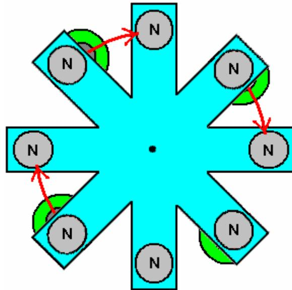
Et si vous allez avoir huit, il n'y a aucun besoin d'avoir les silhouettes V-shaped qui créent juste la turbulence en lançant, faites donc la circulaire de rotor :
