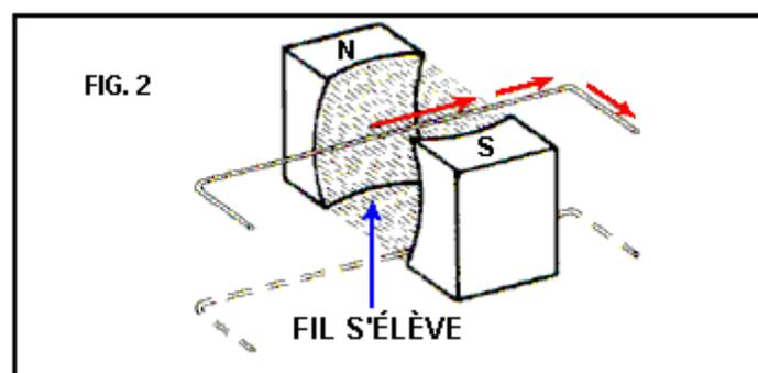
Si le fil est déplacé en haut par le même champ magnétique, donc le courant coulant dans les mouvements métalliques dans la direction opposée. Pourquoi ? Comment le courant "sait-il" quel la façon d'aller ?
