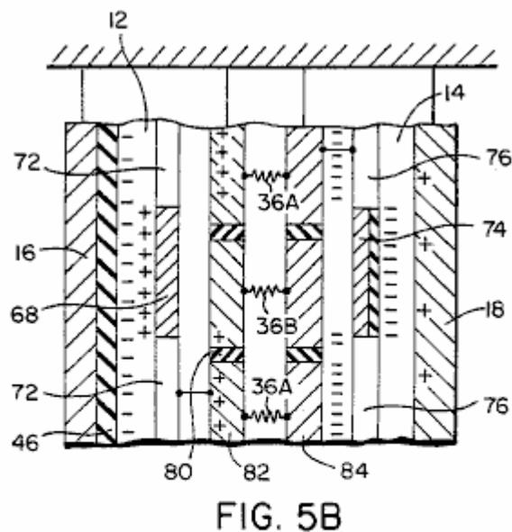
Fig.5A et Fig.5B sont schématiques partiel a disposé des vues supérieures du générateur électrostatique de Figs.2-4, dans les conditions de distribution de charge statiques et dynamiques, respectivement.
