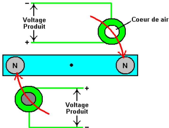
Il suit alors, que cet arrangement automobile pourrait être introduit dans un circuit existant sans affecter l'opération de ce circuit. L'arrangement y ressemblerait :
