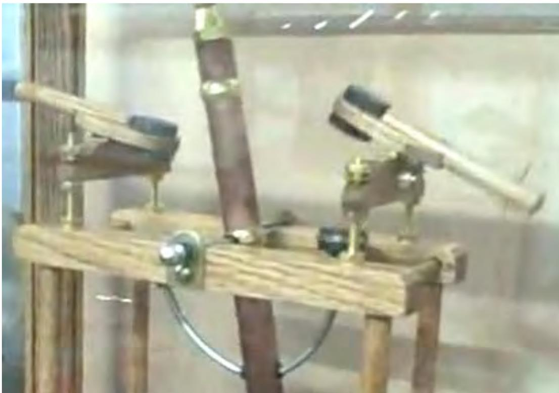
Vraisemblablement, le bras a courbé pour éviter les complications de construction au pendule pivotez qui serait causé par un bras de l'installation droit a attaché à l'arbre du pendule. L'aimant du soulèvement a attaché aux poussées du pendule la fin de l'aimant du bras de la bascule vers le haut bien qu'il ne vienne pas près de lui.
