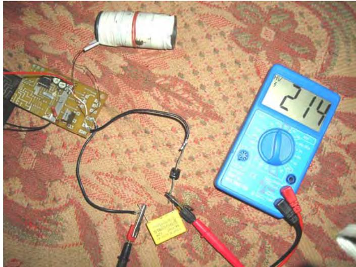
C'est le premier pas dans le processus comme le même circuit peut être utilisé pour conduire beaucoup de bobines de ce type. La résistance qui nourrit la base du transistor est approximativement 500 ohms pour le prototype, mais utiliser une 390 résistance de l'ohm avec une résistance variable d'en série dit, 1K, permettrait à une bonne valeur de la résistance standard d'être sélectionné pour chaque paire du transistor/bobine:
