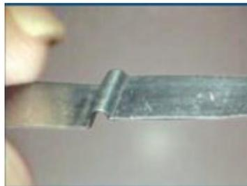
A cause des changements de température, les cellules et les rubans s'expandent et se rétrécissent. Cette courbure est alors indispensable pour garder les connexions intactes. Cela a pour but d'améliorer énormément la longévité des connexions.
