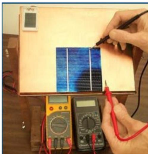
Utilisez un multimètre pour tester vos cellules, en les exposant au soleil selon un angle optimal. Testez-les le même jour ! Sinon vous risquez de voir des écarts de résultats de tests assez importants.
