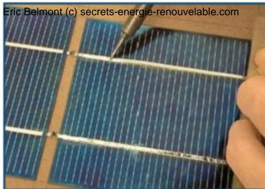
Pour rendre la soudure plus pratique, étalez votre rangée de cellules sur un support longiline en bois par exemple. De cette manière, vous pourrez les retourner facilement lors de la mise en place sur un support principal. Cela permet aussi d'éviter que les soudures se cassent en tenant directement les cellules lors des manipulations.
