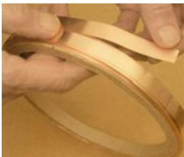
Nous utiliserons 2 types de rubans : une qui sera d'une largeur de 5mm environ, et une autre, 2x plus large : 10mm environ.
