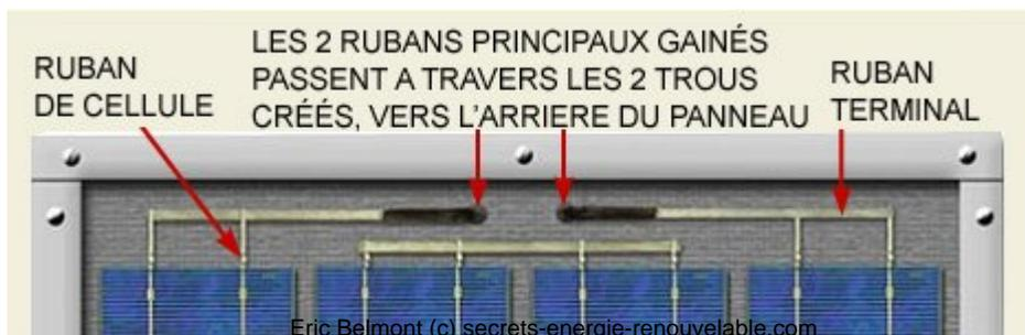
Sur la figure ci-dessus, nous avons donc fini de souder les 2 rubans terminaux aux rubans venant des cellules placées tout en haut, à l'extrémité gauche et droite. En soudant ces rubans, nous avons placé un petit bout de bois entre le support et les rubans à souder, pour éviter tout dégât sur le support.
