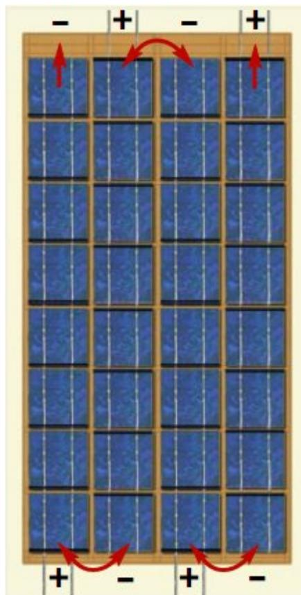
Chaque rangée se terminera par 2 rubans sortant à l'arrière de la dernière cellule. Ce sera la **borne positive de la rangée**. A l'autre extrémité, ce sera la **borne**
